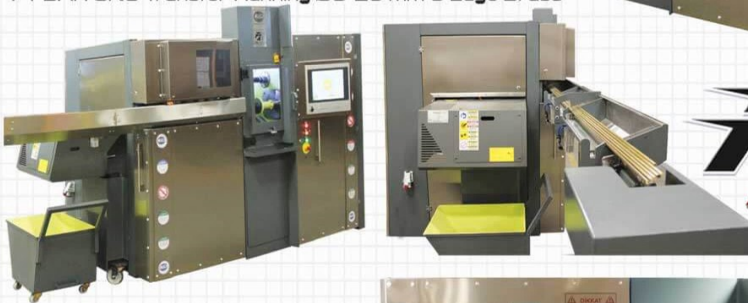
F1 BAR CNC Transfer Running \varnothing 5-20 mm 6 Edge Brass
